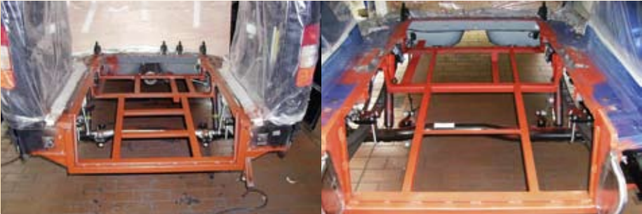
In der Gegenüberstellung offensichtlich: Bis zu 84 Prozent Material wurden eingespart. (l. vorher, r. nachher)
