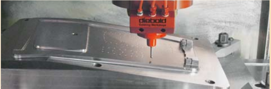
Luftdüsen statt Ölschwall: Der Mediumverteiler bläst Späne beim Fräsen vollständig weg.
